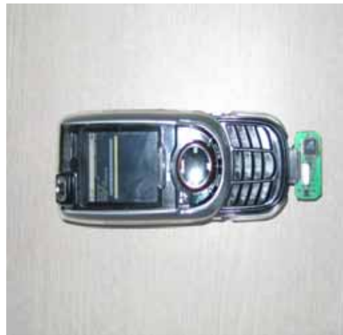
▶▶ 그림 5. 모바일 기기에 보조저장장치 부착 방법
