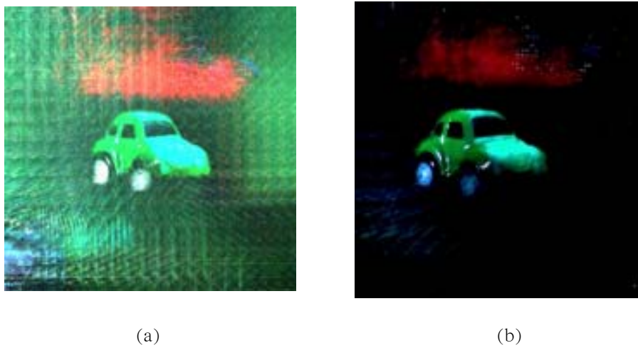
Fig. 3. (a) 은폐하는 물체의 blurring 효과를 제거하기전의 영상 복원 (b) blurring 효과를 제거한 후의 영상 복원
