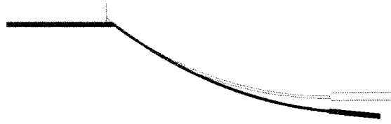
Fig. 8 단조공정과 굽힘공정을 동시에 수행한 후 스프링백량
