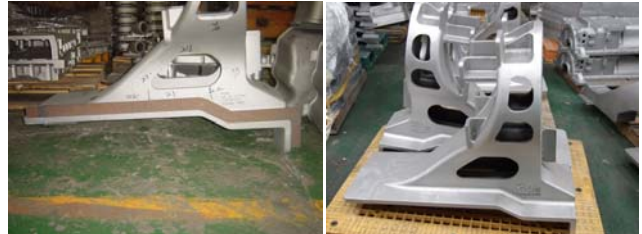
그림 12. T6 열처리 후 변형 검사 및 완성된 air bag support 제품
