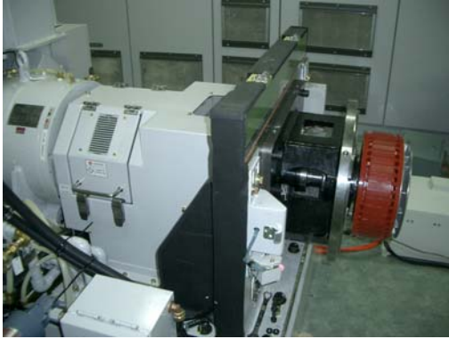
(a) 견인전동기 성능시험 (회전자 장착)
