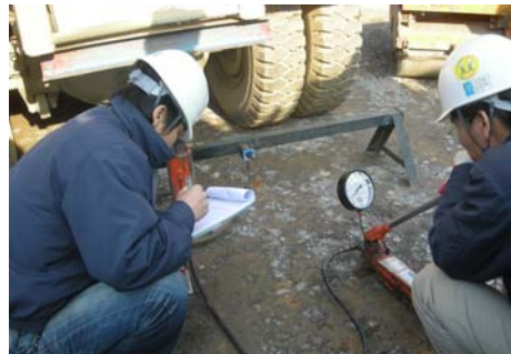
그림 1. 현장 평판재하시험 전경
