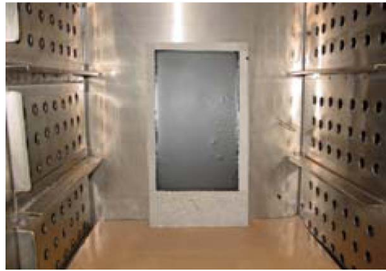
사진5 . 온도별 흘러내림 저항성능 시험 현황
