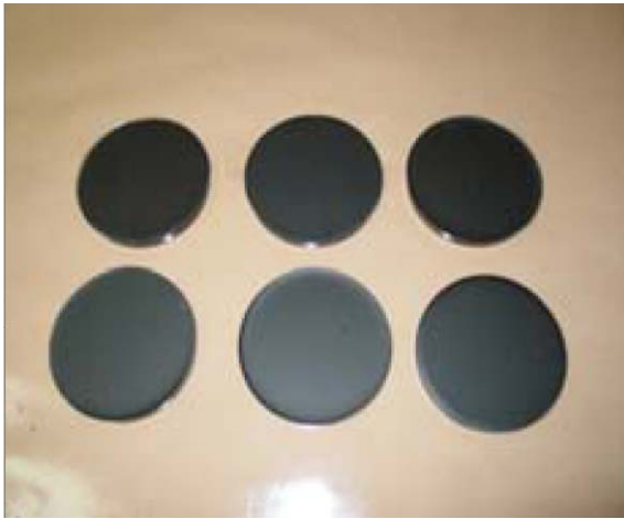
사진6. 수중유실 저항성능 시험 현황
