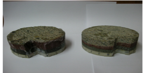
사진8. 투수저항성능 시험 현황
