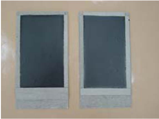
사진5 . 온도별 흘러내림 저항성능 시험 현황
