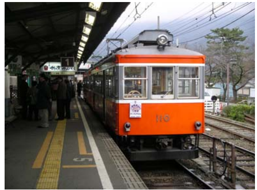
그림 2. 일본 동경부근 하코네에서 운영중인 일반철제차륜형 산악용 경량전철 (최소곡선반경 30m, 최대등판능력 80%)
