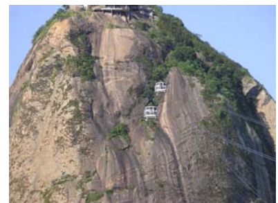
그림 7. 케이블카가 서로 대중 역할위하여 동시에 출발 중간에서 서로 만나는 모습
