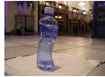
그림1. 산정상과 하부의 기압차에 의한 변형(예)
