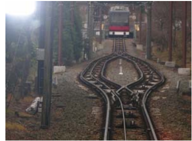
그림 8. Cable Pulling형 산악 경량전철 (앞에 보이는 복선 선로는 교행설비임)
