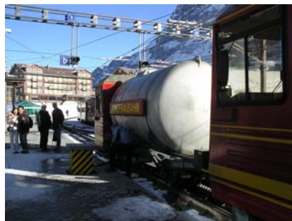
그림 3. 정거장에 용수를 공급 하기위한 물탱크 운반차량
