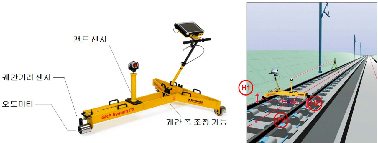
그림 3. GRP 1000 장비구조
