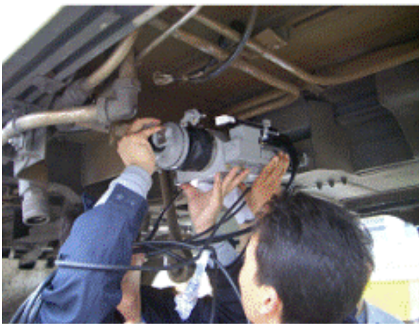
그림4 세미 액티브 서스펜션 설치
