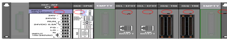
그림 1. TODS의 주제어부 PLC 모델 구성
