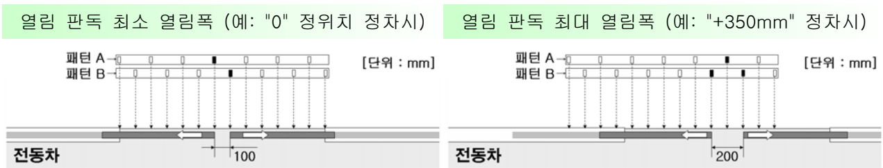
<그림 10> 열림 판독 시점의 전동차 출입문 열림폭(기준 방식)
