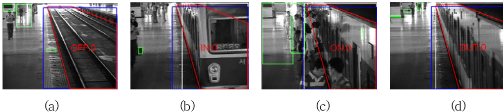
그림 6. 열차 상태판별 결과; (a) OFF 모드, (b) IN 모드, (c) ON 모드, (d) OUT 모드
