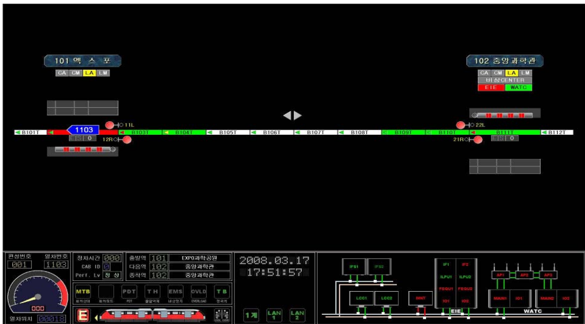
그림5. 자기부상열차 위치 및 궤도 점유 상태 표시
