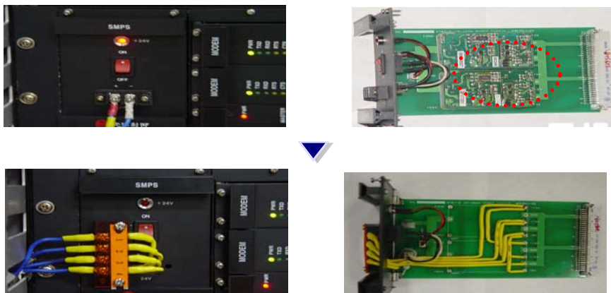
<그림10. RTU MODEM 전원장치 조치방안>
