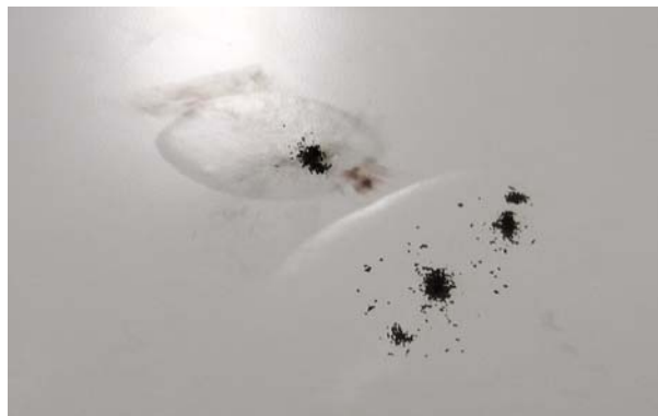
그림 7. 탄소섬유 복합체의 표면손상
