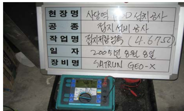
그림 5. 접지스테이션 접지저항 측정(전위강하법)
