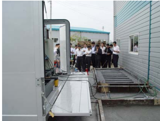
그림 7. 콘크리트위에 시공된 시험용 접지 스테이션
