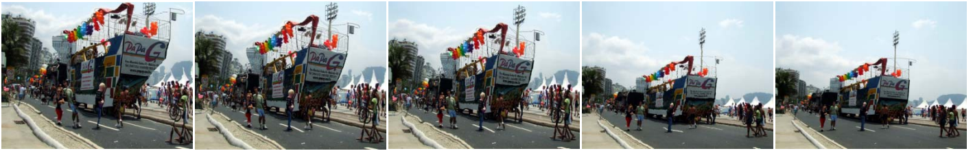
그림 2 자유도 확산을 이용한 심 카빙 기법 결과. 원본 영상의 가로, 세로 모두 이분의 일로 축소. 왼쪽에서 오른쪽으로: 각각 확산 함수 p(v) = 0 (본래의 심 카빙 결과), p(v) = v/2 , p(v) = v , p(v) = 1.0 를 사용한 결과. 가장 오른쪽: 균일 샘플링 결과
