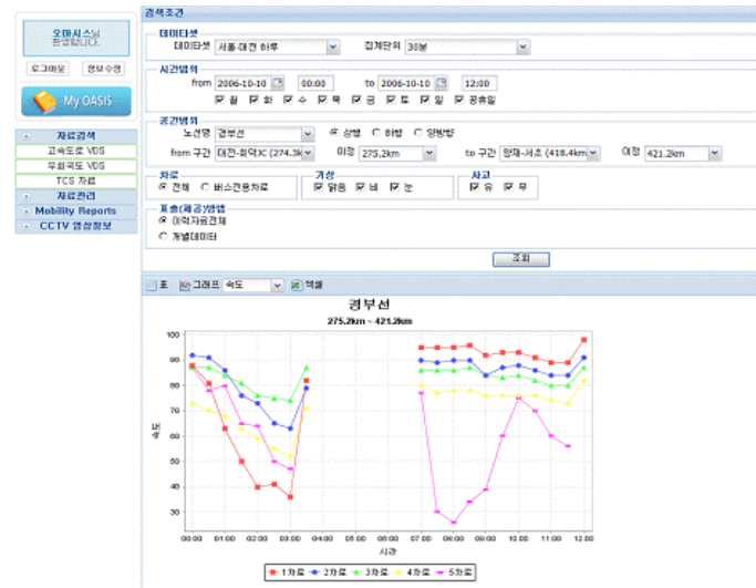
(그림 5) 고속도로 VDS 차로별 속도 그래프 조회 결과
