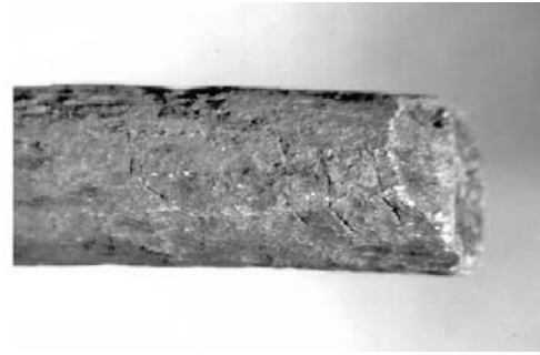
그림 3 강선 표면에 심각한 크랙이 발생했음을 보여주는 사진
