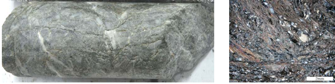
그림 11. 단층영향대의 시추코어 및 박편 사진
