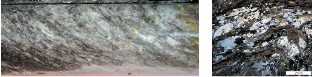
그림 10. 석영편암의 시추코어 및 박편 사진
