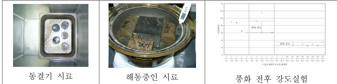
그림 17. 산 침수에 의한 동결-융해 실험 및 결과
