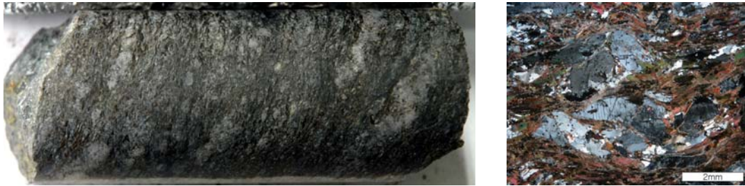
그림 9. 운모편암의 시추코어 및 박편사진
