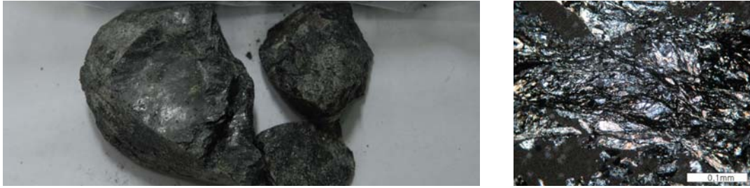
그림 13. 단층암(변질) II 의 시추코어 및 박편 사진
