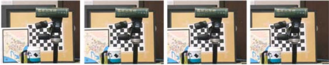
그림 5. 합성 된 영상 시퀀스. 가장 좌측의 영상은 기준 영상이며 그 우측 영상들은 계산 된 가상 시점의 영상이다. 가장 우측의 영상은 기준 영상에 대해 가장 큰 변위(disparity)를 갖는다. 각 영상에서, 배경 부분의 체스보드 패턴의 텍스처가 올바르게 보간 되었음을 확인 할 수 있다.
