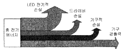
그림 1. LED 등기구의 에너지 입력, 손실과 광출력 모식도
