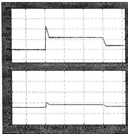
그림 5. DC/DC converter 출력 전압/전류
