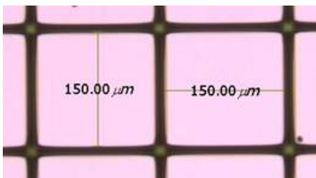
그림 3.1. 유리기판위에 격벽패턴이 형성된 사진
