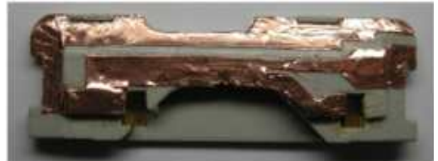
[그림 3] 제작한 안테나 [Fig. 3] fabricated antenna
