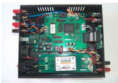
그림 4. 신호발생 및 공정제어 장치 내부 모듈
