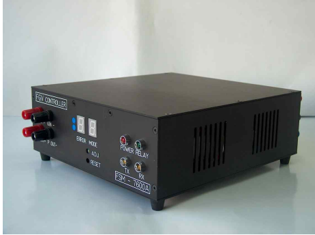
그림 8. FGV 테스트 패턴발생 및 공정제어 시스템
