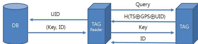
<그림 4> RFID 인증 메커니즘 구성도
