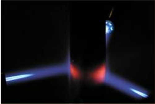
Fig. 14 Thermal fatigue Burner rig test
