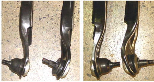
Fig. 11 LCA의 좌굴 발생 후 B 포인트 부의 형상
