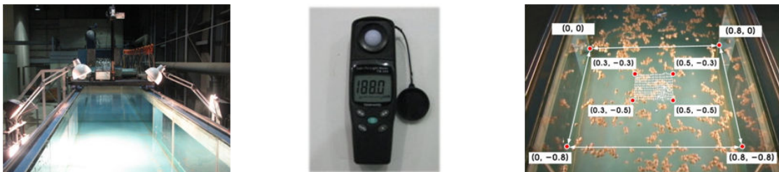
Fig. 1 빛의 밝기에 따른 정확도 분석을 위한 실험 장치와 유속측정 영역
