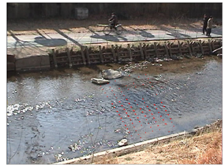
그림 2. 표면영상유속계에 의한 유속 측정
