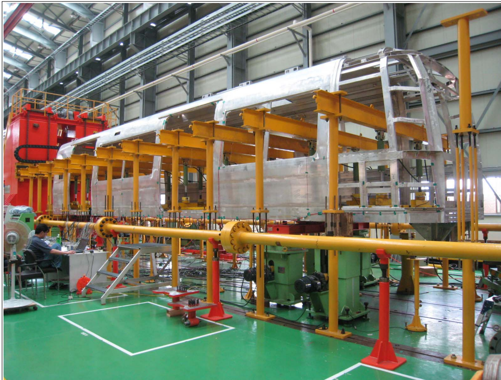
그림2. 하중시험용 차체 설치
