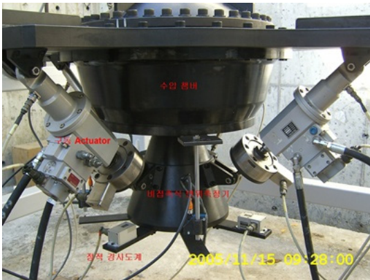
Fig. 1 수압시험챔버 및 구동장치 구성
