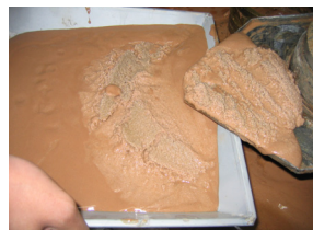
(a) 무게비 10% Bentonite 1
