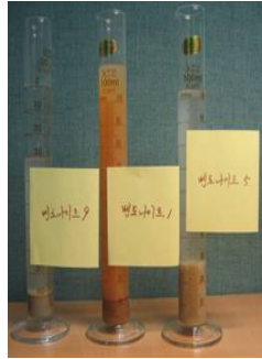
그림 3. Free Swell 시험 모습
