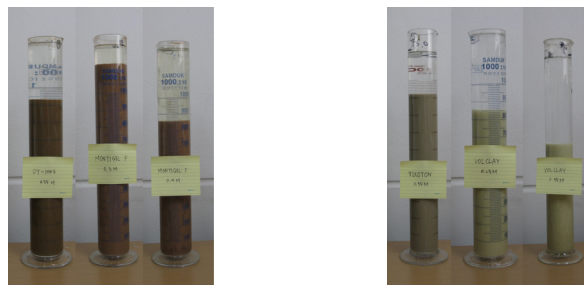
그림 4. 벤토나이트 침강시험 모습
