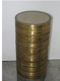
그림 13. 재료분리 시험장비에 채워진 벤토나이트 시료
