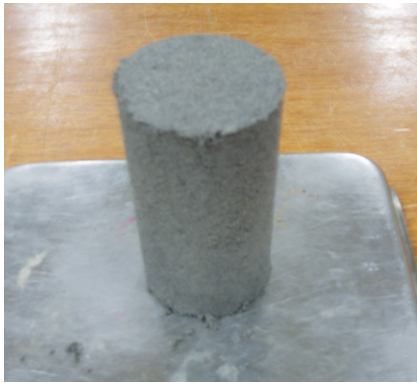
그림 5. Bottom ash의 삼축압축시험 전경
