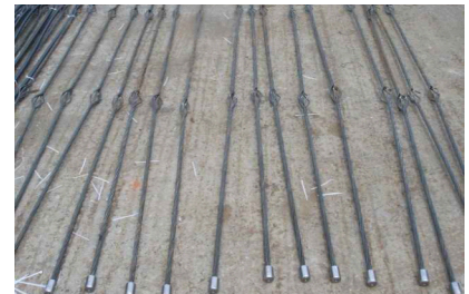
그림 2. 케이블 보강재 전경
