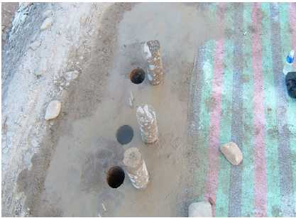
사진 1 현장 코아채취 전경
