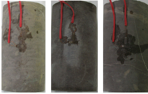
사진 3. 공시체 및 게이지 부착 장면
