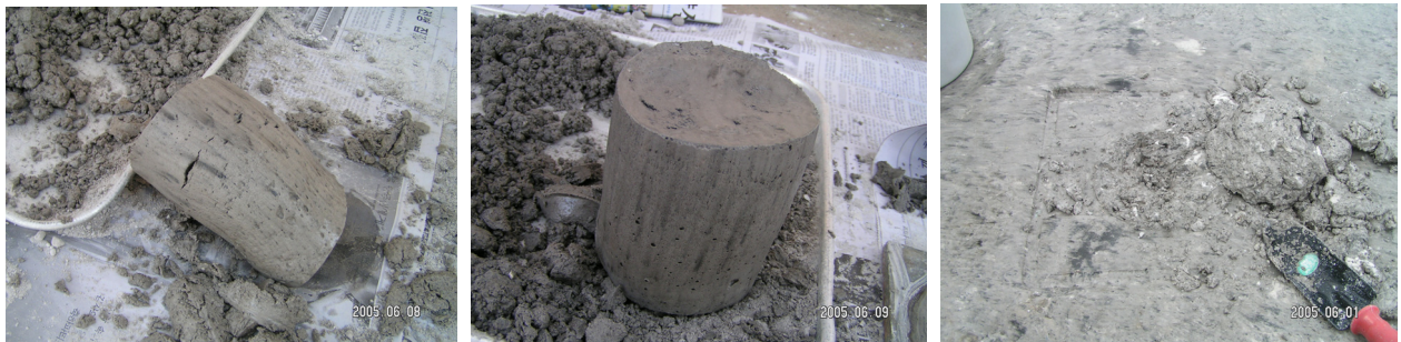
(a) 축조재료 다짐시험시 스폰지현상이 발생한 시편 (b) 현장들밀도시험시 스폰지현상 그림 8. 석고 다짐시 스폰지현상
