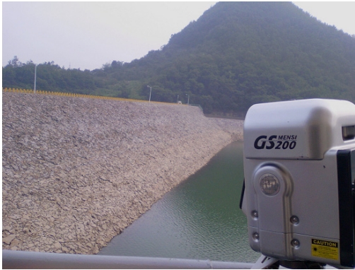
그림 4 취수탑에서의 스캐닝측정 전경
