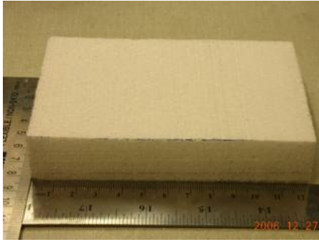
그림 3. 지오포름 모델 블록 및 제작 완료 후 원심모형시험의 모델
