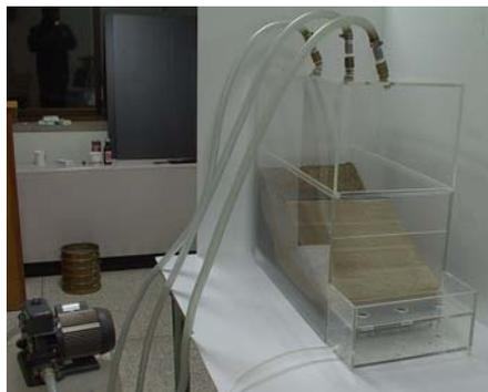
그림 8. 장비의 구성 및 강우강도 측정
