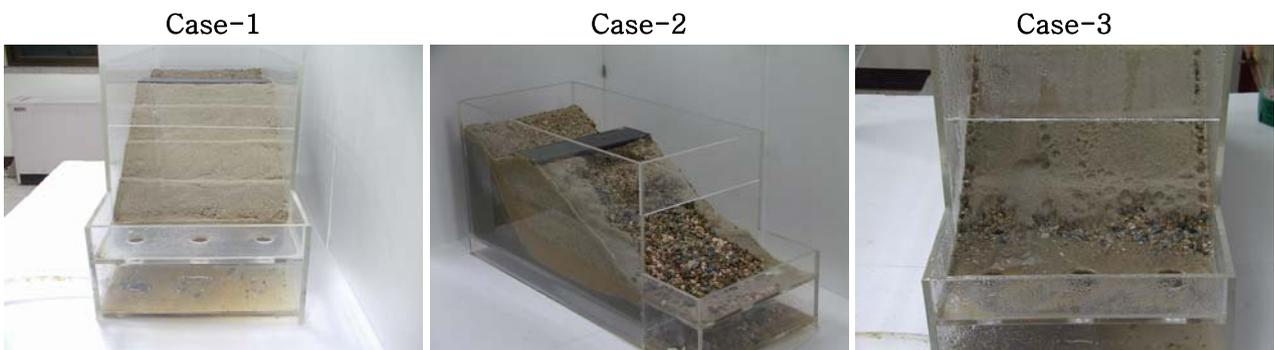
그림 9. Case별 시험 후 사면 형상
