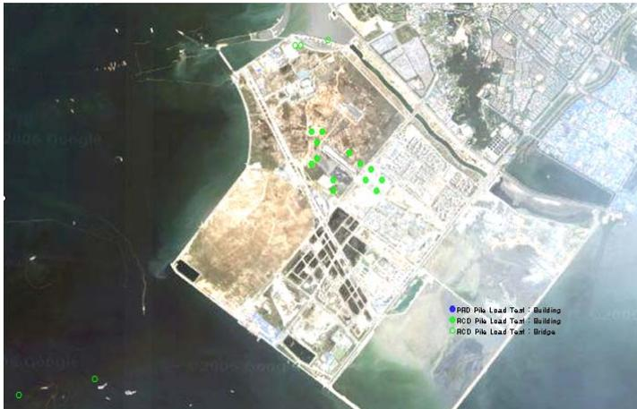
그림 6. 인천 송도 자유무역지역 초고층기초 대구경 말뚝 시험 현황
