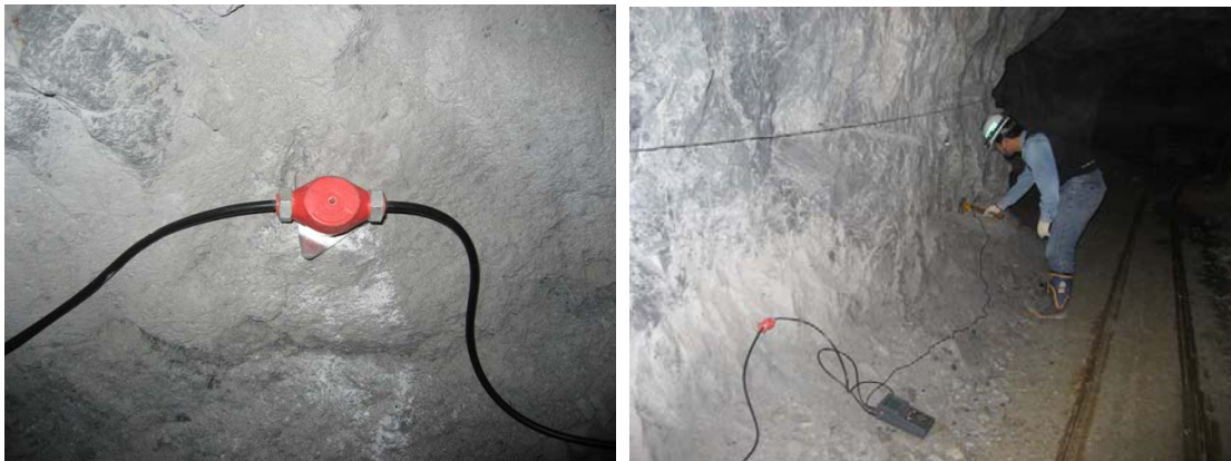
그림 11. 현장탄성과 측정용 지오폰과 측정모습
