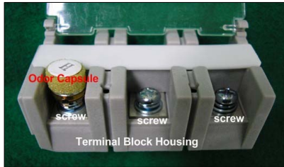
(a) 단자대에 설치된 캡슐
