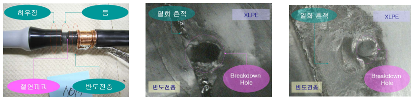
(a) 파괴 위치 (b) 틈 5mm일 때 형상 (c) 틈 10mm일 때 형상
