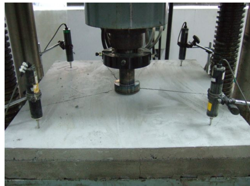
<그림 3> 온돌층 균열하중 측정 전경
