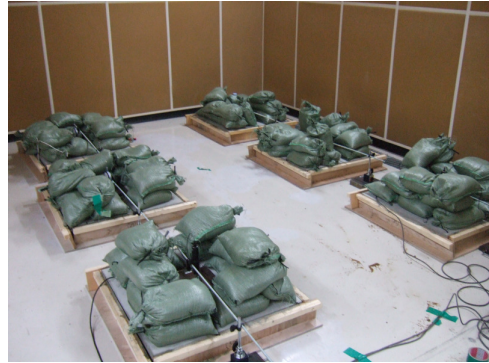
<그림 2> 완충재 포함 온돌층 장기처짐량 측정 전경
