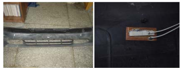
그림 2 범퍼와 범퍼에 부착한 PZT 센서
