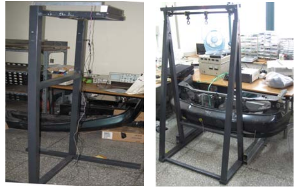
그림 1 충격 시험을 위한 테스트 리그
