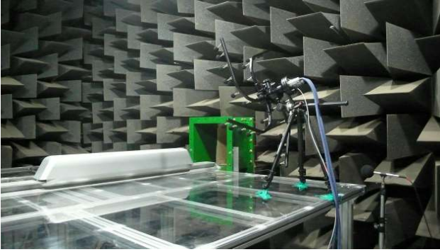
그림 2 자기부상열차 모형 측정광경 사진
